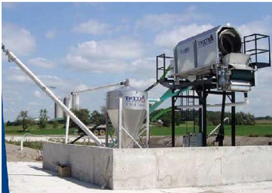
Полная комплектация цеха состоит из бункера-напителя сапропеля естественной влажности, перемешивающего устройства его с коагулянтом, насоса и трубопровода подачи массы на узел сепарации, сепаратора - обезвоживателя сапропеля, трубопровода с насосом отвода жидкости и склада-бункера твердой фракции.
